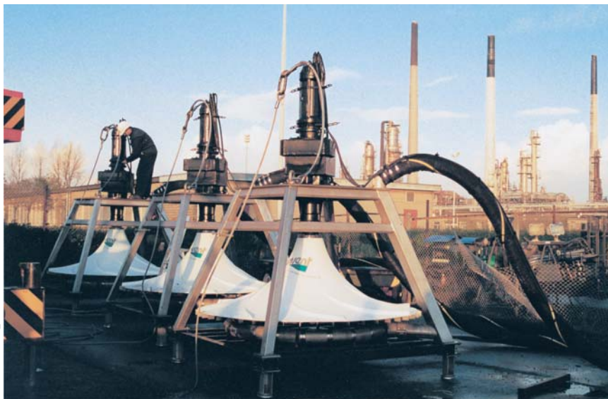
3 sistemas de agitación HYPERDIVE ® de un total de 4 en una planta de tratamiento industrial en Holanda (industria petroquímica)
