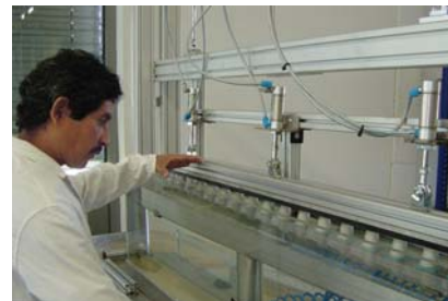
Inspección de un distribuidor de aire
