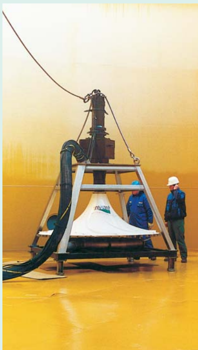
1 sistema de agitación y aireación HYPERDIVE® de un total de 4 en una planta de tratamiento industrial en Holanda (industria petroquímica)
